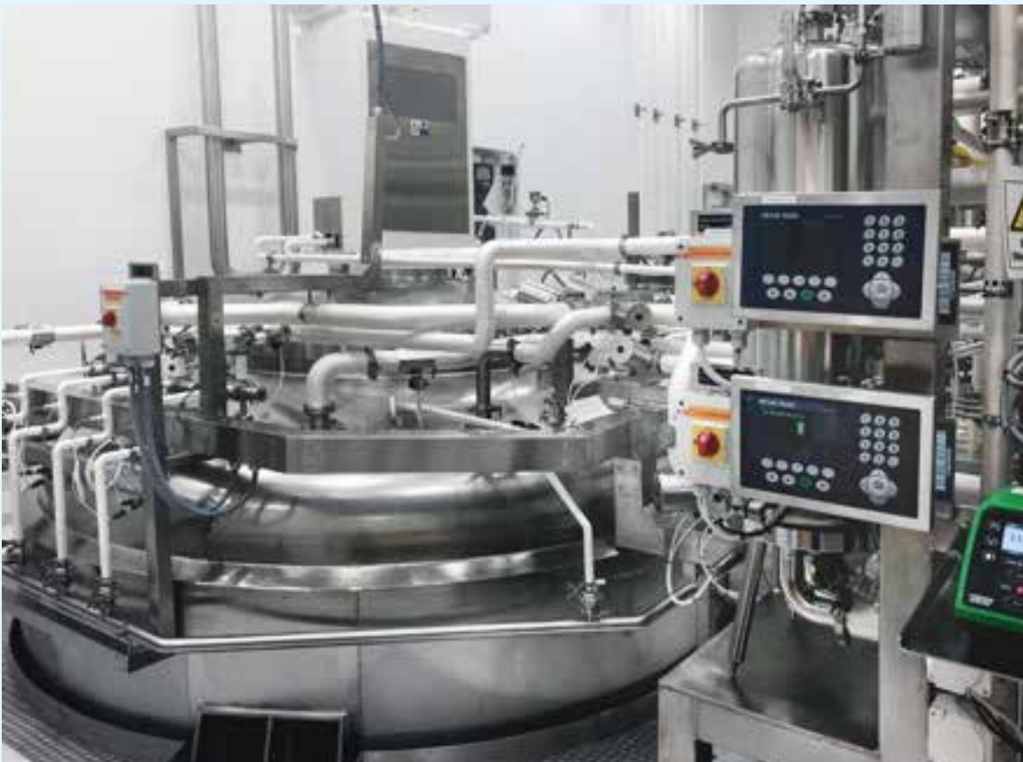
İsviçreli kimyasal firması Lonza'ya ait 20.000 litrelik bir biyoreaktör kabı
